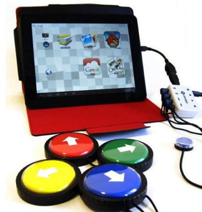
Figura 1: Acceso a un ordenador mediante conmutador
